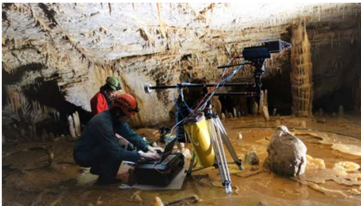
Figure 9 : Grotte de Bruniquel. Caractérisation chimique des stalagmites et spéléofacts à la spectrométrie laser - LIBS (Laser Induced Breakdown Spectrometry).
