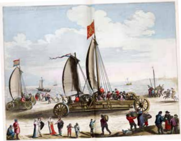
Le char à voile construit pour le prince Maurice de Nassau (estampe de 1649, auteur inconnu).
