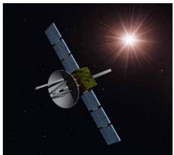
Figure 10 : L'infortunée sonde japonaise Nozomi, lancée vers la planète Mars en 1998 et dont l'électronique de contrôle a été irrémédiablement endommagée par les particules d'une éruption solaire en avril 2002, l'empêchant d'atteindre sa destination (Source : Nesnad, Wikipedia)
